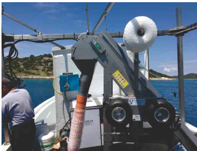
Slika 28.: Punilica za školjkaše u dvostruku mrežnu cijev, stroj za navlačenje mrežnih cijevi na cijev za punjenje, konstrukcija od nehrđajućeg čelika na koju se postavljaju strojevi i oprema i pogonski dizel motor s vodenom pumpom i s hidrauličkom pumpom za pokretanje ugrađenih strojeva
