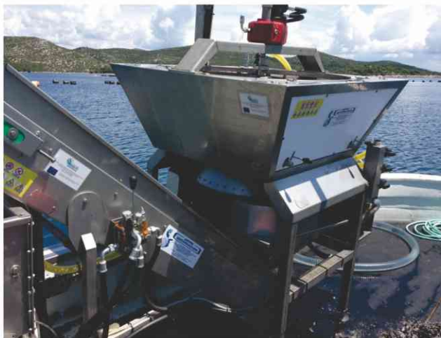
Slika 26.: Bubanj za odvajanje školjkaša prije sortiranja
