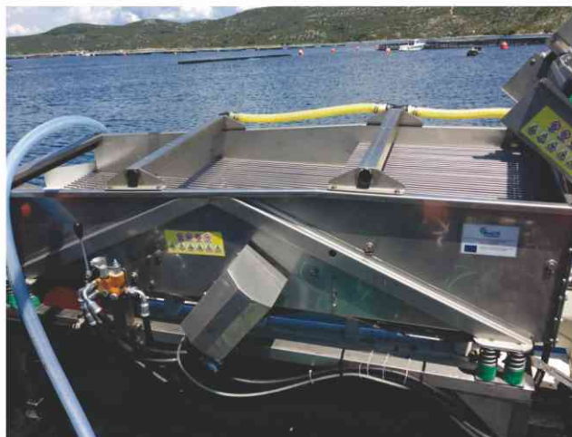
Slika 27.: Vibrirajući sortirni stol
