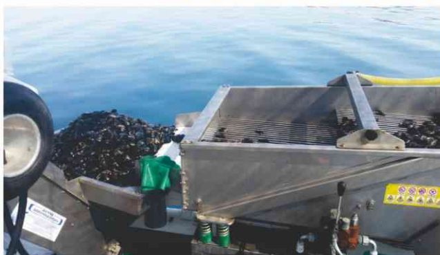
Slika 32. Sortiranje daganja na vibrirajućem sortirnom stolu
