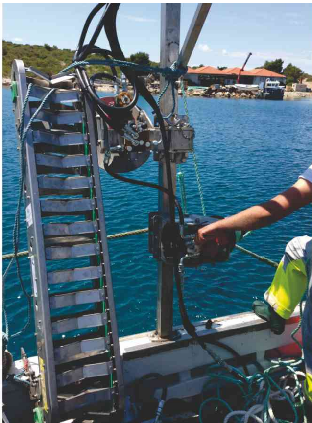
Slika 29.: Pokretna traka za uvlačenje čarapa s dagnjama na plovilo, zvijezde za povlačenje uzgojnih linija za školjkaše i vitla za podizanje uzgojnih linija za školjkaše i za povlačenje brodice po sidrenoj mreži kaveznog uzgajališta riba
