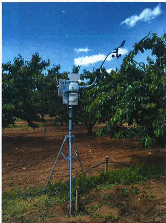
Slika 1. Meteo stanica sa senzorom za smjer i brzinu vjetra Izvor: Magdalena Baričević
