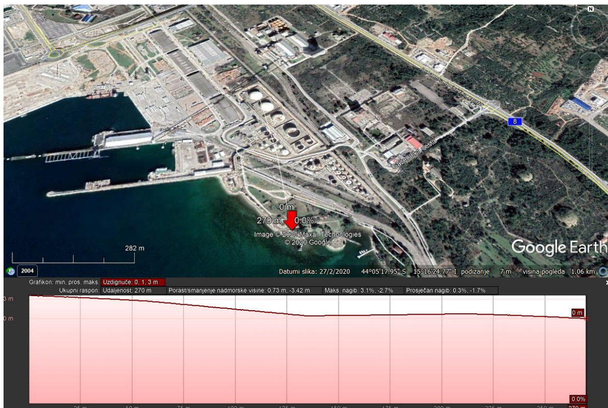
Slika 11. Visinski odnosi od spremničkog prostora preko vagon pretakališta do mora
