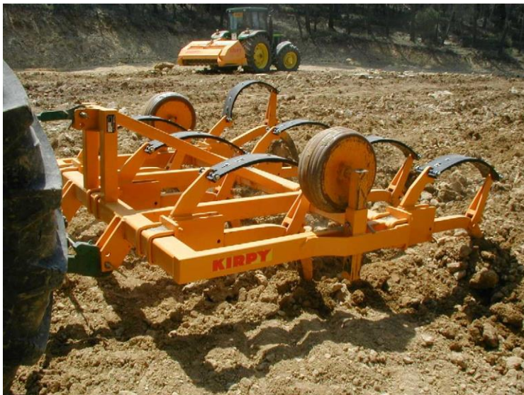
Slika 3 Šizela ravna teren i izbacuje krupno kamenje na površinu tla
