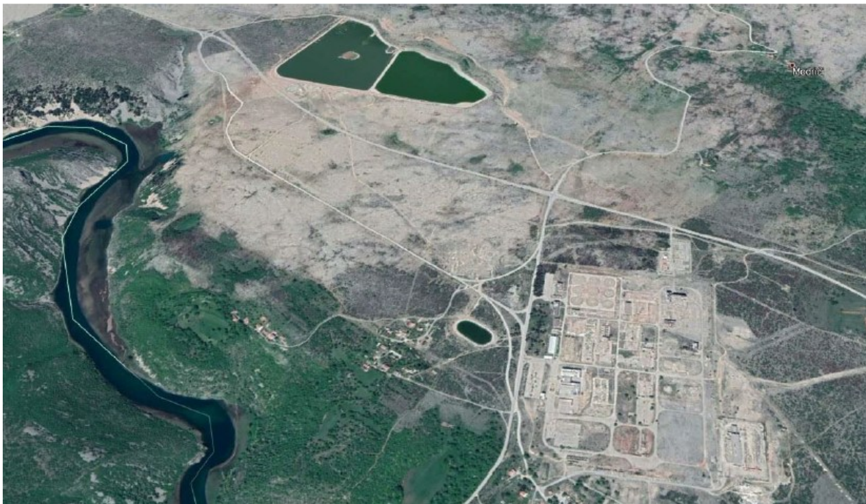
Slika 3-16: Onečišćenje u blizini lokacije zahvata, bivša tvornica glinice Jadral i bazeni crvenog mulja i otpadne lužine.
